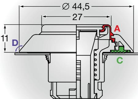
**B:** En el caso de los accionadores giratorios, por ejemplo selectores de contacto sostenido o con retorno por resorte, esta protección se consigue ya que la membrana de sellado, sujeta en el lado del selector, se extiende sobre el bisel o parte fija, es decir, que no se produce un espacio antihigiénico cuando se activa el accionador. Otra membrana de sellado en el interior del dispositivo protege además contra la introducción de agua a presión.
